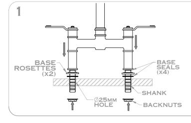
ONCE UNPACKED REMOVE BACKNUTS, PULLDOWN WAND & WEIGHT READY FOR INSTALLATION.
