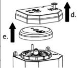
6. Lift away lid & knob (d) and styrene insulation (e).
